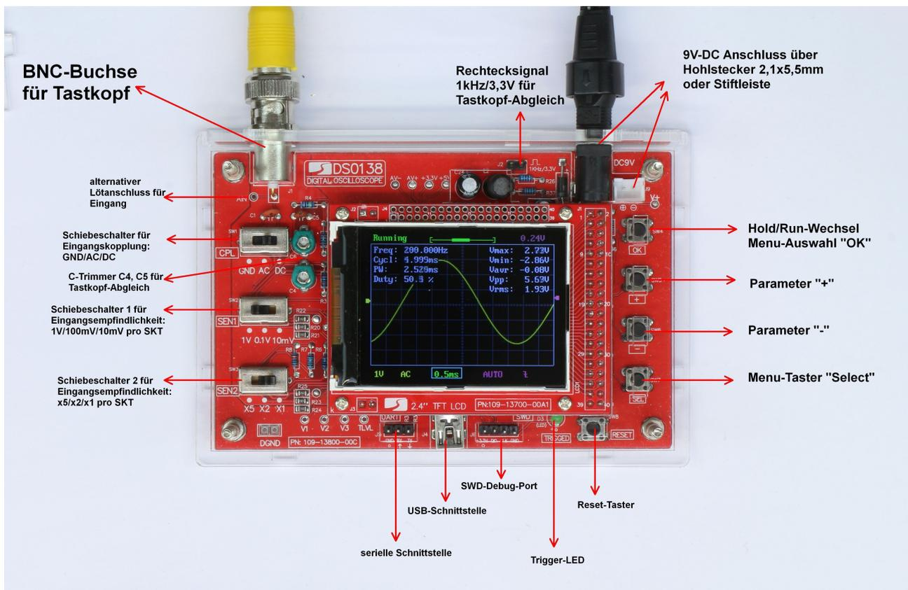
Abbildung 1: Übersicht Anschlüsse und Bedienelemente des DSO138
