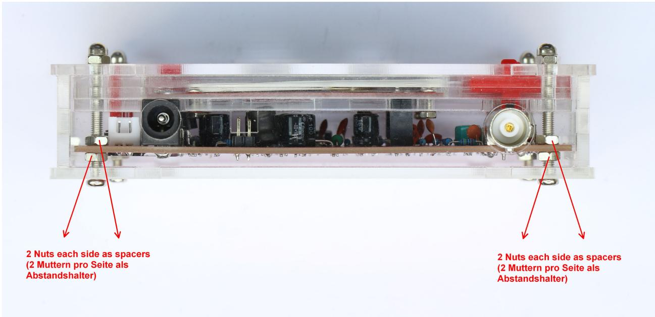
Abbildung 4: 4 Muttern als Abstandshalter für die Platine. Seitenansicht des fertigen Gerätes
