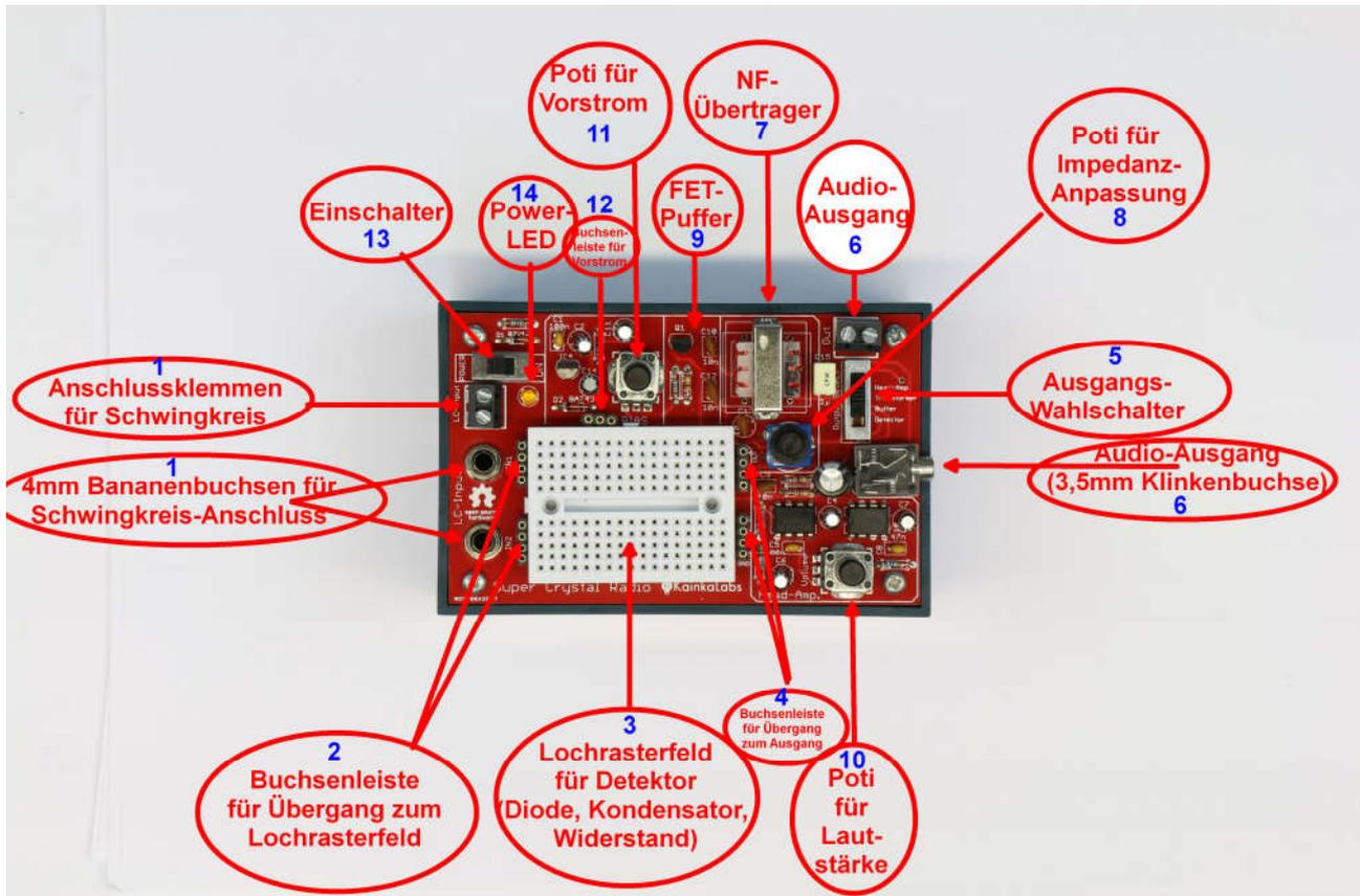
Abbildung 1: Funktionselemente des Universellen Detektor-Empfängers
