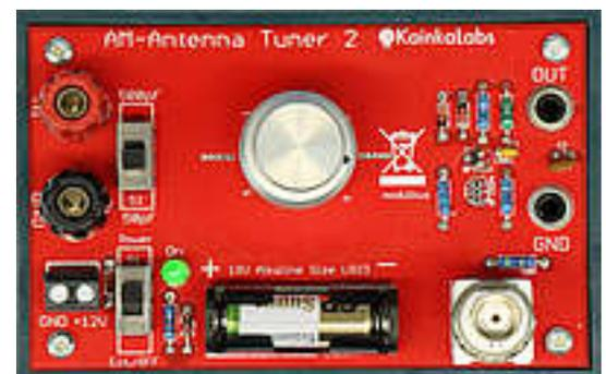
Abbildung 15: VCAP4 mit 1:6 Feintrieb im AM-Antenna-Tuner 2-Gear
