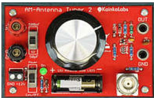
Abbildung 16: VCAP4 mit 45mm-Drehknopf im AM-Antenna-Tuner 2
