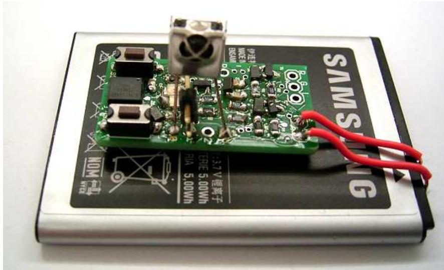
Ideal wäre es, wenn jede beliebige Infrarot-Fernbedienung auch die LED-Lichter ein- und ausschalten könnte. Und das geht! Auf den Sparrow wird ein üblicher IR-Empfänger gelötet. Das Empfangssignal geht an B0, parallel zu S1. Da es ebenfalls aktiv low schaltet passt beides zusammen. Alles wird nun über einen Li-Akku aus einem defekten Smartphone betrieben.
