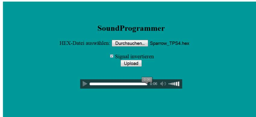
Der Sparrow erwartet die Einstellung "Signal invertieren". Nichtinvertierte Signale kann man verwenden um einen Tiny13 mit zwei Widerständen und einer Reset-Taste zu programmieren(vgl. Kap. 10).
