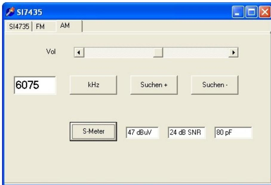
Schon ohne eine angeschlossene Antenne kann der Empfänger mit dem eigenen Quarzoszillator getestet werden. Der Suchlauf stoppt auf 4 MHz und Vielfachen davon. Auch im UKW-Bereich findet man Signale z.B. bei 92 MHz und bei 100 MHz. Die angezeigte Signalstärke kann Hinweise auf die optimale Antennenkopplung geben. In den AM-Bereichen wird auch die automatisch eingestellte Kreiskapazität angezeigt. Damit weiß man ob die Spule im richtigen Bereich arbeitet.
