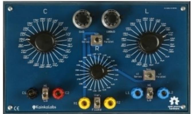
Mit diesen RLC-Boxen können Sie in Sekundenschnelle einen Wert aus 48 Widerständen, Kondensatoren oder 44 Induktivitäten in einem Bereich von bis zu 6 Dekaden auswählen.
